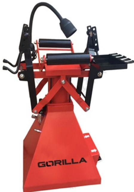
El abridor o separador de neumáticos de llantas es una herramienta utilizada principalmente en talleres de reparación de neumáticos para abrir y mantener abierto un neumático mientras se realizan reparaciones internas, como parches, inspección de daños o recauchutado.
