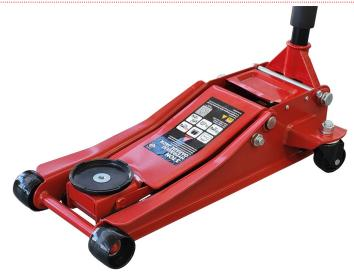
La gata hidráulica tipo lagarto de 3 toneladas es una herramienta utilizada para levantar objetos pesados, como vehículos o maquinaria, de hasta 3 toneladas de peso. El perfil bajo le permite deslizarse debajo de vehículos bajos con facilidad. Funcionan utilizando un sistema hidráulico que emplea un pistón impulsado por aceite para levantar la carga.
